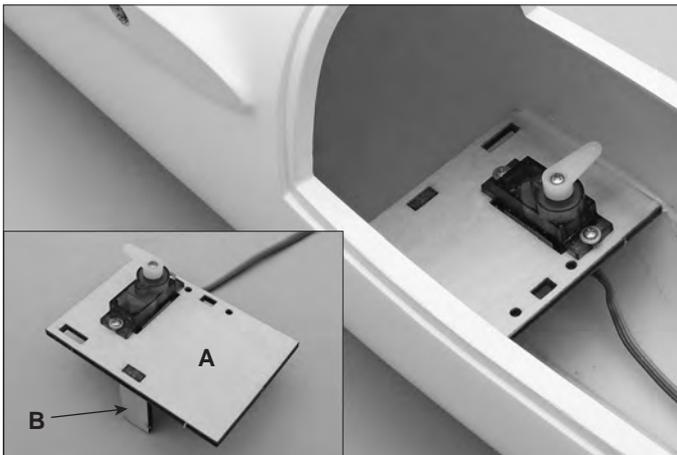
(1)瞬間接着剤HWを使って胴体サーボマウントを写真のように組み立てます。ラダーのサーボを写真の様に搭載します。サーボとサーボマウントを胴体内にはめ込み、エポキシ接着剤で接着します。
