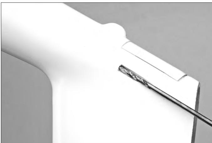
(2)胴体のロッド出口に $3.5\text{mm}$ の穴をドリルで開けます。
